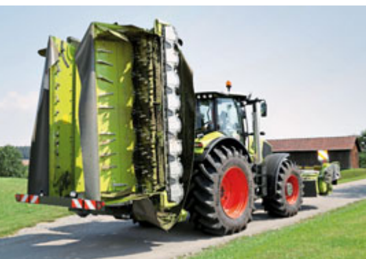
Die Seitenklappen zur Straßenfahrt mittig zusammen. Der Beleuchtungsträger ist Serie, die LED-Beleuchtung gehört ebenfalls zur Serienausstattung.
