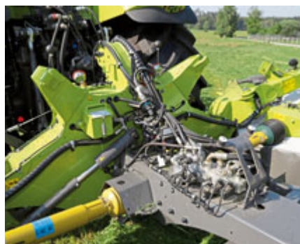
Die Hydraulikkomponenten sind zentral untergebracht und nach Entfernen der Schutzhaube gut zugänglich. Der Hydraulikzylinder sorgt für die Vorgewendestellung.
