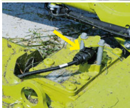
Sichhilfen wie die beiden Pfeile auf jeder Maschinenseite erleichtern dem Fahrer die Maschineneinstellung (Bild oben). Zahlreiche Sensoren, wie dieser auf dem Mähwerksgetriebe (Pfeil) ermöglichen die Überwachung vieler Parameter.
